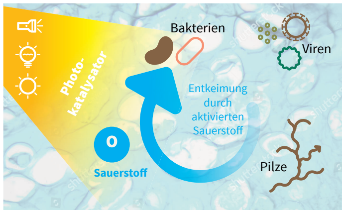
Photokatalytischer Prozess – Wirkungsweise
